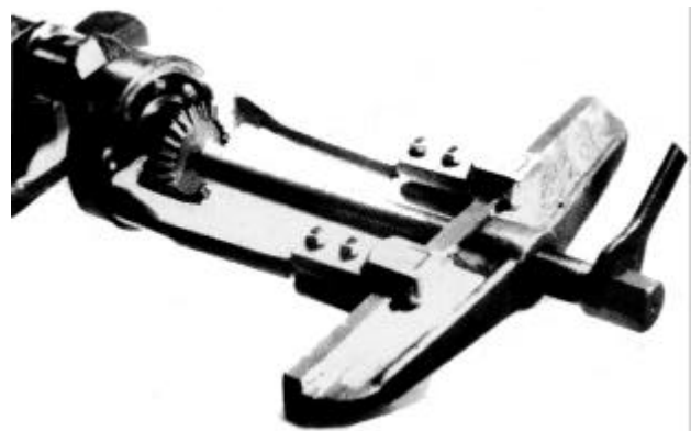
Abb. 2-13 Abziehen des Kegelrades von der Kurbelwelle mit Universalabzieher
