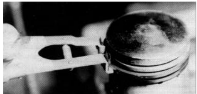
Abb. 2-19 Kolbenringmontage mit Universalzange
