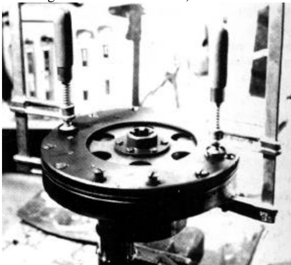
Abb. 2-25 Demontage der Kupplung
