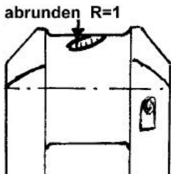
Abb. 2-12 Ausgebauete Kurbelwelle mit Ölaustrittsbohrungen
